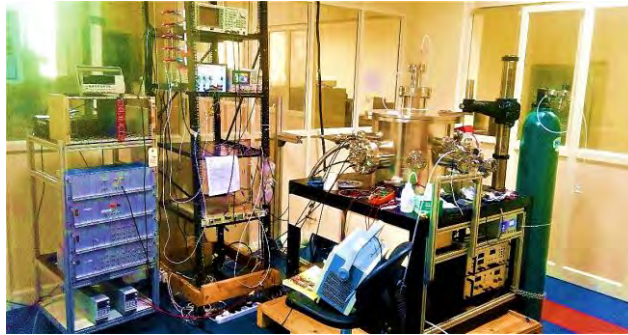
चित्र 5. उड़ान-समय सूक्ष्म-कण द्रव्यमान स्पेक्ट्रोमीटर (TOF-AMS) की एकीकृत प्रणाली की प्रयोगशाला
