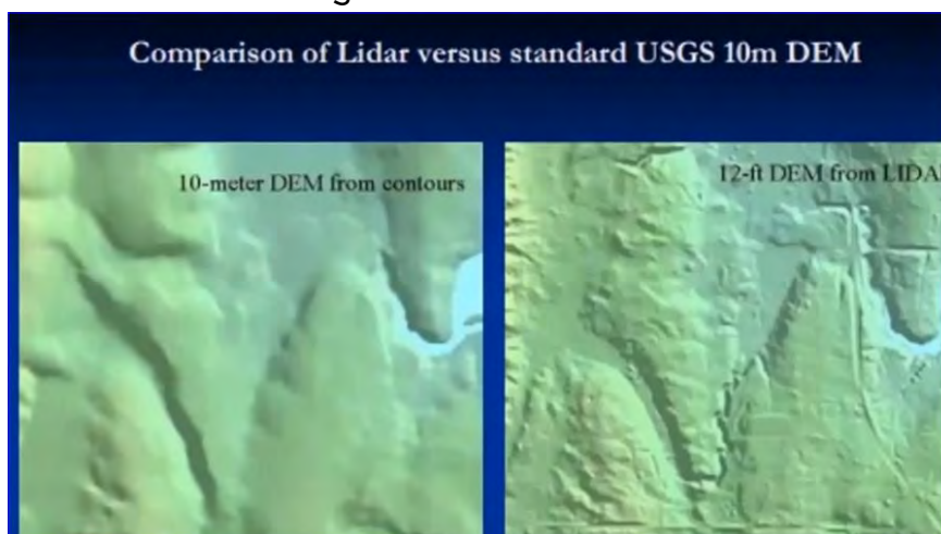
चित्र -10 कंटूर द्वारा निर्मित DEM और लायडार द्वारा निर्मित DEM
