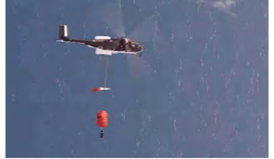
चित्र सं 7: इलेक्ट्रान राकेट के बूस्टर की मिड एयर रिकवरी (क्रेडिट - राकेट लैब)
