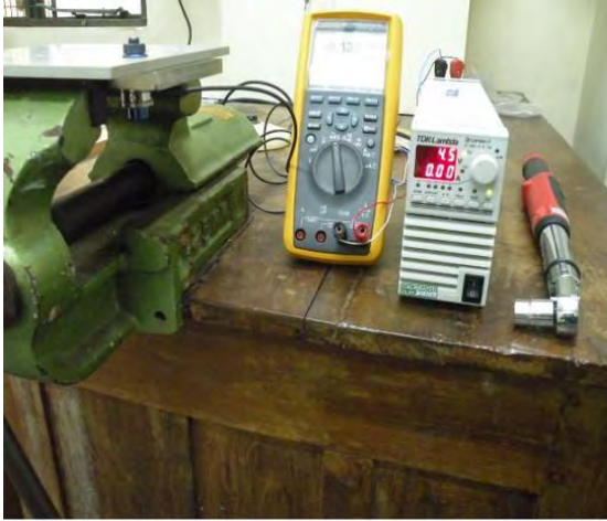
चित्र (1) नट कारक मूल्यांकन परीक्षण जमाव चित्र (2) बोल्ट फोर्स सेंसर अंशांकन जमाव
