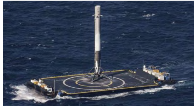
चित्र सं 5: रेट्रो प्रोपल्शन का उपयोग फाल्कन 9 के बूस्टर की लैंडिंग
