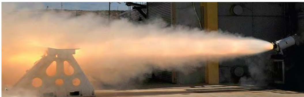
चित्र सं. 15: अभिवर्धक पृथक्करण मोटर का स्थिर परीक्षण। (स्रोत: NASA)
