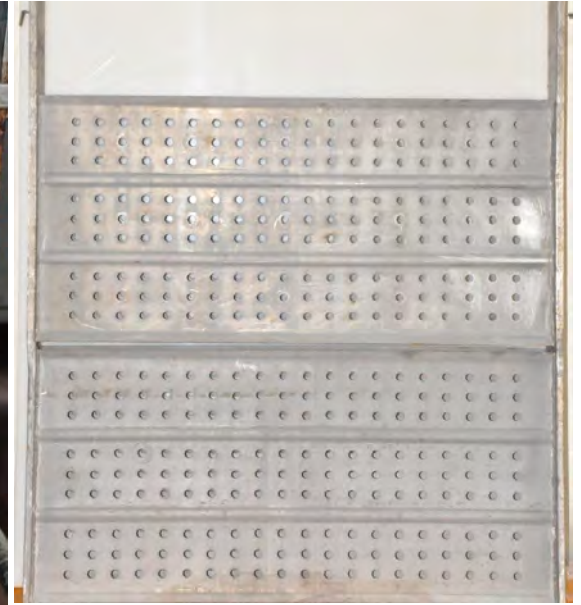
चित्र 13- 5% HCl से 5 मिनट और उसके बाद 25% नाइट्रिक अम्ल से 60 डिग्री पर 15 मिनट उपचारित कैथोड
