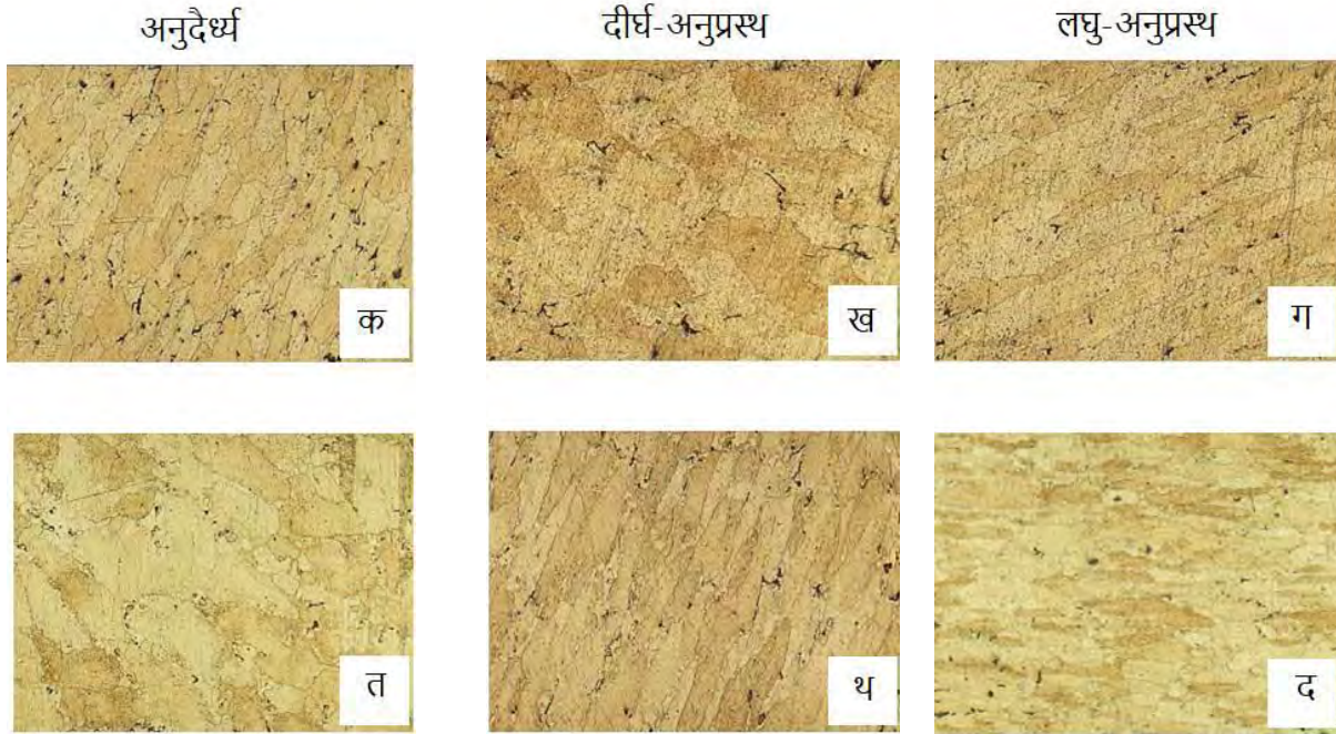
चित्र 5: 100x आवर्धन पर सूक्ष्म-संरचना (क, ख, ग - मद 1; त, थ, द - मद 2)
