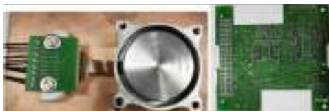
मैग्नेटो टॉर्कर्स के प्रोटोटाइप (एयर कोर और परमैडर कोर)
