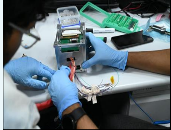
वायरिंग हार्नेस की रूटिंग: हर तार पर लेबल लगा हुआ है, हर कनेक्शन सोच-समझकर किया गया है।
